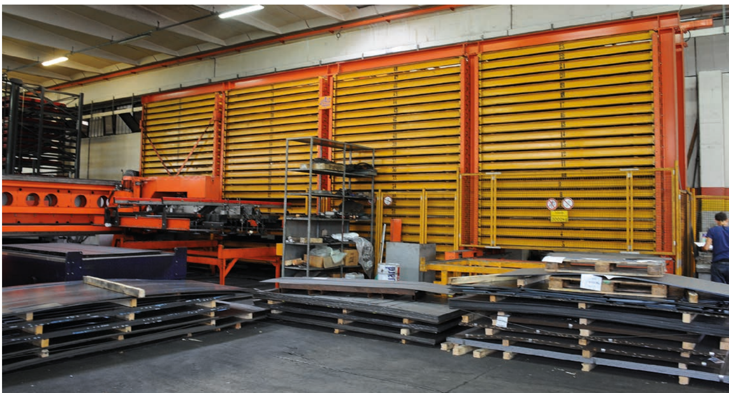
Sono 97 le cassette da 30 quintali ciascuna che compongono il magazzino automatico presente in Kosmolam dal 1996.
